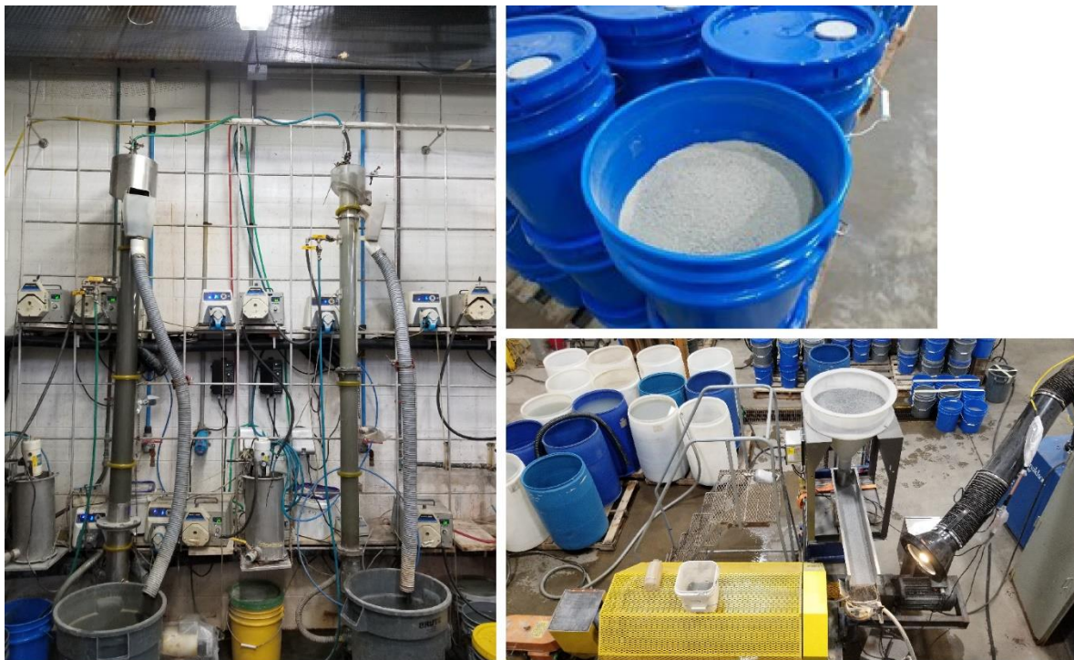
Abbildung 1. Homogenisierte Erzprobe der J Zone (oben); Rougher-Scavenger-Säulenflotation (links); Schüttgutmahlkreislauf (rechts)
